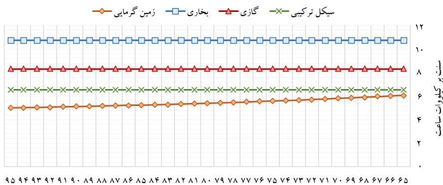
نمودار (۶): حساسیت هزینه تمام شده واقعی نسبت به ضریب ظرفیت نیروگاه زمین گرمایی
